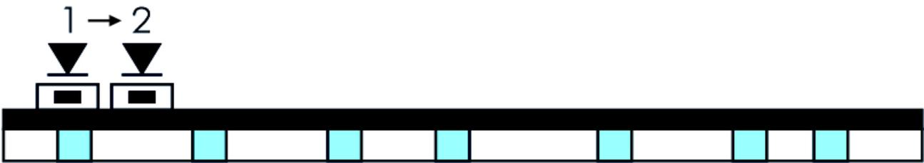
Halten Sie die Taste S1 gedrückt, drücken und halten Sie dann die Taste S2, bis die gewünschte Helligkeit erreicht ist. Solange beide Tasten gedrückt werden, ändert sich die Helligkeit langsam bis zum Maximal- oder Minimalwert. Um die Laufrichtung (heller/dunkler) zu ändern, halten Sie beide Tasten gedrückt, bis die Maximal- oder Minimalhelligkeit erreicht ist. Lassen Sie dann beide Tasten los und beginnen den Vorgang von vorne.
