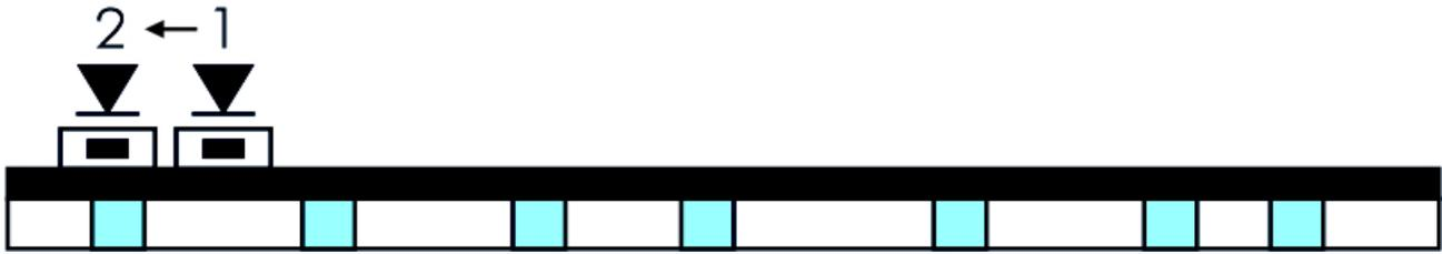
Halten Sie die Taste S2 gedrückt, drücken und halten Sie dann die Taste S1, bis die gewünschte Helligkeit erreicht ist. Solange beide Tasten gedrückt werden, ändert sich die Helligkeit langsam bis zum Maximal- oder Minimalwert. Um die Laufrichtung (heller/dunkler) zu ändern, halten Sie beide Tasten gedrückt, bis die Maximal- oder Minimalhelligkeit erreicht ist. Lassen Sie dann beide Tasten los und beginnen den Vorgang von vorne.
